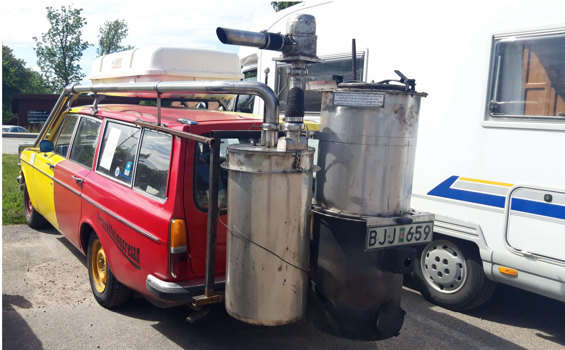
100% regenerativer Antrieb – zum Betanken werden Axt und Säge benötigt, in der Dachbox ist der Holzvorrat
